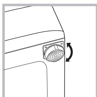
2. Jeśli podłoga nie jest idealnie pozioma, należy skompensować nierówności, odkręcając lub dokręcając przednie nogi (patrz rysunek); kąt nachylenia, zmierzony na górnym blacie pralki nie powinien przekraczać 2°.
